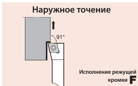
Исполнение режущей кромки **F**
