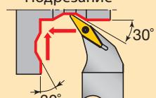
Исполнение режущей кромки Q
