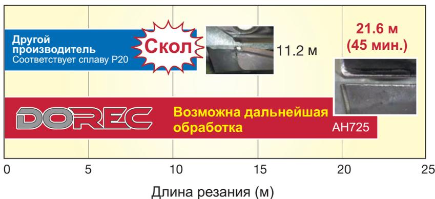
Диаметр инструмента:  $\varnothing 25$  мм
